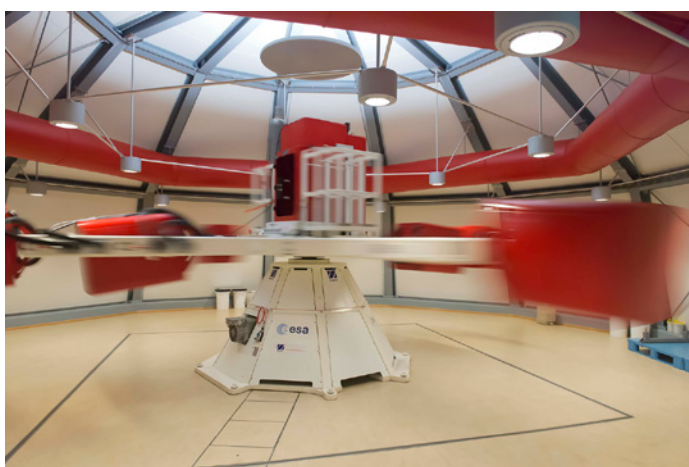
Fig 1. Stor centrifug Centrifugen är inte framtagen för astronautträning utan för forskning. Samfinansierad av ESA och den holländska regeringen är den tillgänglig för ett flertal applikationer. Centrifugen har diametern 8 m och kan ge upp till 20 g, med fyra gondoler som tar emot upp till 80 kg nyttolast samt med en central kontrollgondol. Två extra gondoler kan sättas fast på mellanarmen för att samtidigt ge olika g-nivåer. Experimenten kan genomföras i upp till sex månader i sträck.
