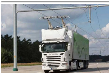
I samarbete med Scania har Siemens demonstrerat tekniken för elmotorvägar. Foto: Siemens
