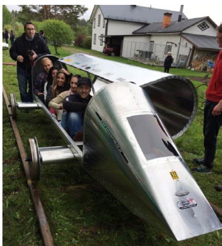
Fig 3. Eximus 1 tillverkades primärt av aluminium för att hålla vikten på ett minimum.
