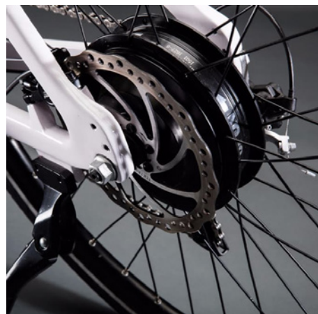
En navmotor på 500 W ger 45 km/h.
