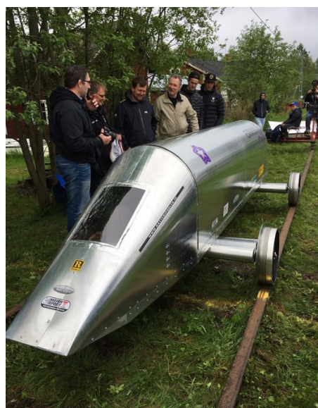
Fig 4. Eximus 1 uppskattas väga ca 100 kg och vara ca 5 500 mm lång och 1 500 mm bred.
