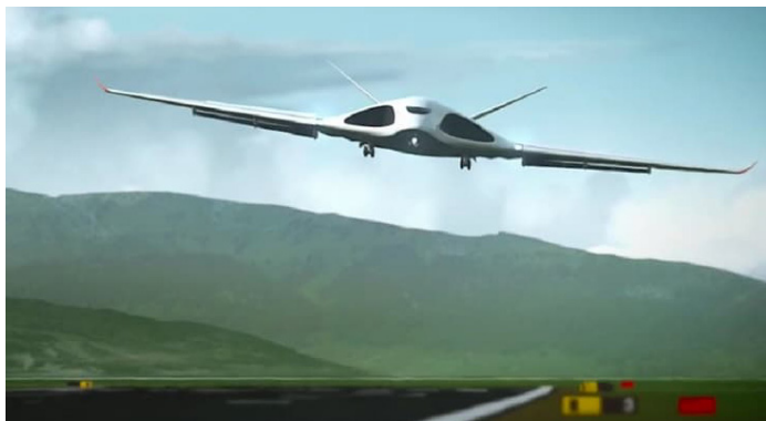
Ryskt koncept på ett flygplan för tunga transporter, döpt till PAK TA, som ska kunna flyga med överljuds fart på upp till 2 000 km/h och lasta nästan 200 ton. (Bild: Aleksey Komarov).
