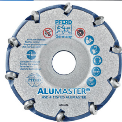
Tio hårdmetallskär på en lätt GFK-skiva: High Speed ALUMASTER® från PFERD Marienheide används för bearbetning av aluminium.
