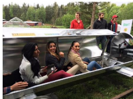
Fig 5. Eximus 1 drivs av fyra 12 V, 45 W batterier parallellkopplade och en 500 W motor.
