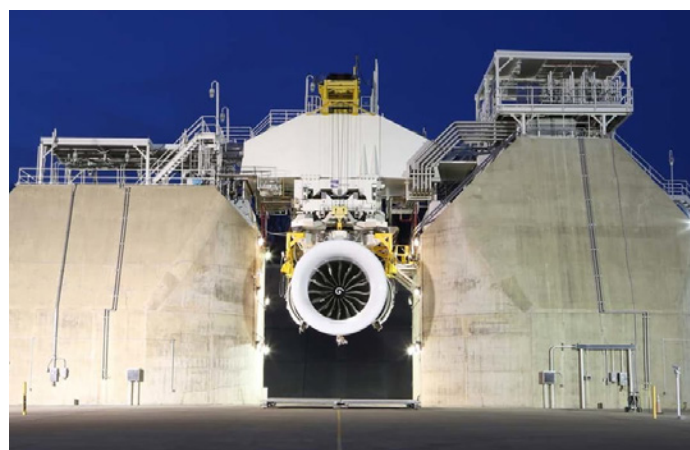
Markprovning på gång för den första GE9X-motorn. (Foto: GE Aviation)
