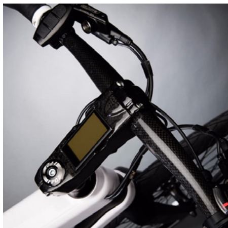
Bluetooth LCD-skärm och reglage + nyckel.
