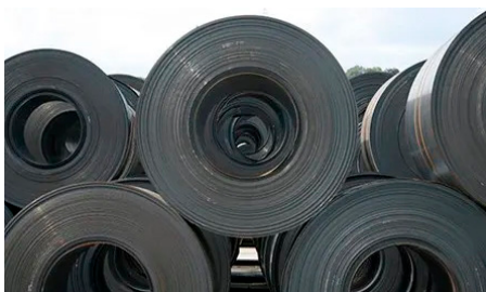
Travar av varmvalsade stålplåtar.
