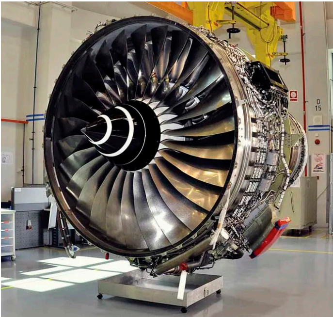
Turbofanjetmotorn ovan innehåller flera MMC-komponenter som hjälper till att göra motorn lätt men ändå stark och förbättra flygplanets effektivitet.
