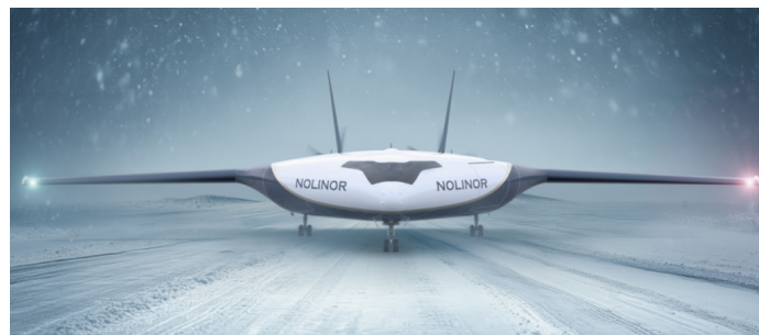
Vingarna och flygkroppen smälter samman till en enhet (Foto: Nolinor Aviation)
