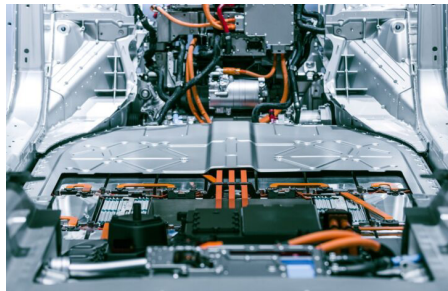
En elektrisk batteribaksida till ett fordon med aluminiumram.
